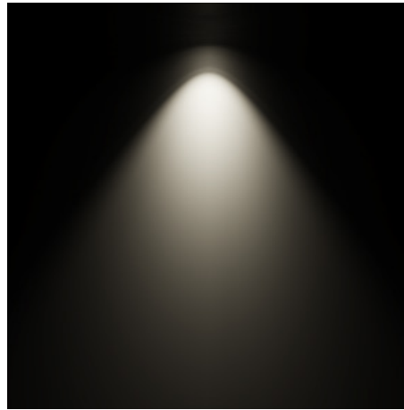
Lichtverteilungskurve GEAR R155 40°
